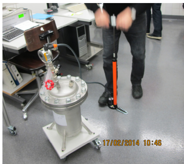
d) Druckaufbau bis p_t = 10 bar mit einer Handpumpe (vorheriger Druckaufbau bis 7.5 bar mit der Druckluftleitung).
