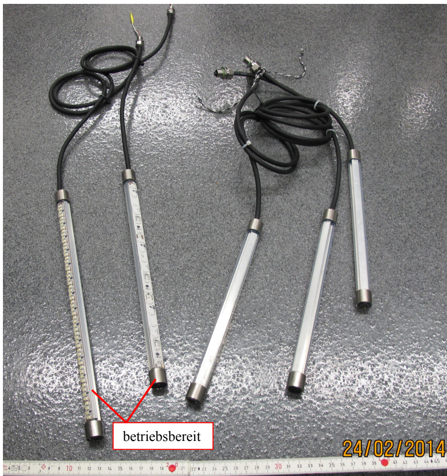
Bild 2: LED-Leuchten des Typs TL 510 im erhaltenen Zustand, für einen Prüfdruck von p_t = 3.5 bar. Typnummer gemäss Tabelle 1: 8.
