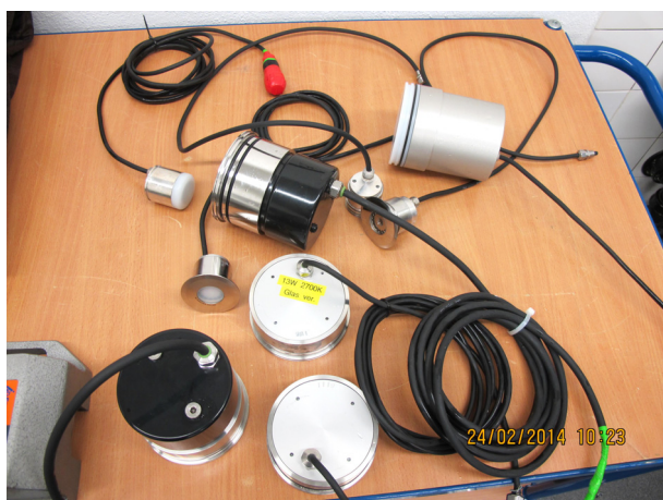
a) LED-Leuchten nach der Entnahme aus dem Druckbehälter
