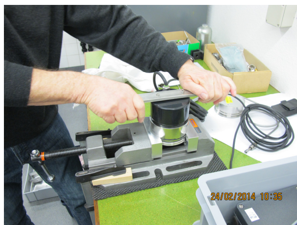
b) Zerlegung des Gehäuses für innere Kontrolle
